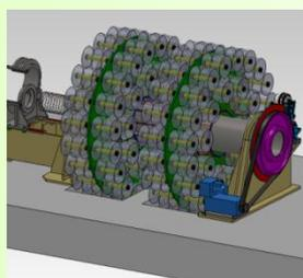
Etudes de machines de câblage pour les câbles Offshore.
